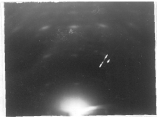
Fig. 102 Bi 2 S 3 on NaCl(100) at 300°C
