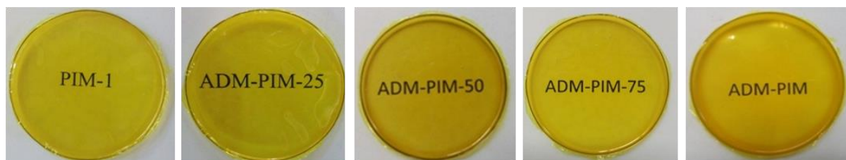
Figure 4.7: Films of a) PIM-1, b) ADM-PIM-25, c) ADM-PIM-50, d) ADM-PIM-75 and e) ADM-PIM
